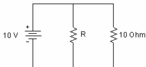
a) Calcular el voltaje a través de R. Determinar el voltaje a través de la resistencia de  $10\Omega$ .
