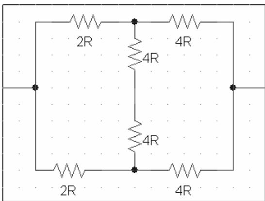
El circuito es el puente de Wheatstone equilibrado, por lo cual no hay corriente a través de las resistencias centrales de 4R
