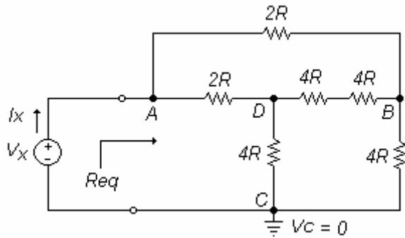
Este problema se puede solucionar conociendo la corriente  $I_x$  que se puede calcular a partir de las corrientes de rama  $I_{AD}$  e  $I_{AB}$ , las cuales a su vez se obtienen de los voltajes y las resistencias entre los nodos A y D y A y B respectivamente:
