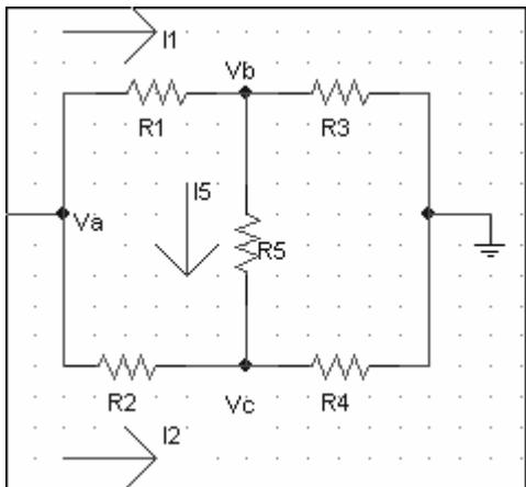
Se busca una relación de  $R_1, R_2, R_3, R_4$  para que  $I_5=0$ .
