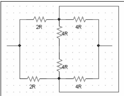
Nuevamente el puente esta en equilibrio entonces  $V_b = V_c$ . Debido a esto, el corto que introduce el interruptor No tiene ningun efecto sobre el circuito y  $Req$  se mantiene
