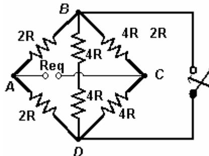
El circuito anterior entre los nodos A y C es equivalente al siguiente, al cual se le ha adicionado una fuente de voltaje de prueba con un voltaje  $V_x$ , que al conectarlo entre los nodos AC produce una corriente  $I_x$ . Por lo tanto la resistencia equivalente será:
