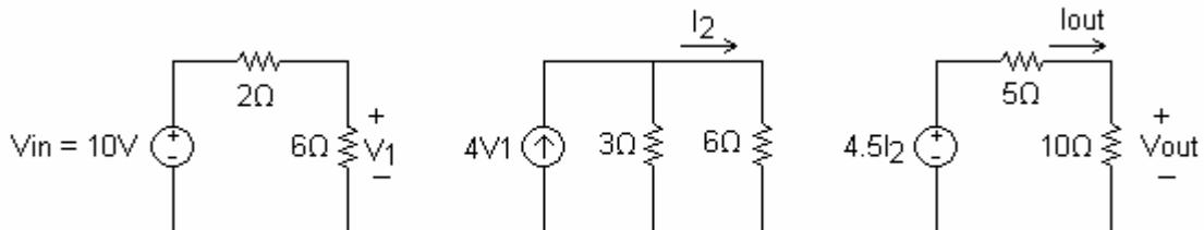
$$\text{Por divisor de voltaje } \rightarrow V_1 = \frac{6\Omega}{6\Omega + 2\Omega} * 10V = 7.5V$$
