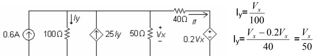
$$\text{Ecuación Nodo } V_x : 0.6 + 25I_y = I_y + \frac{V_x}{50} + I_1$$
