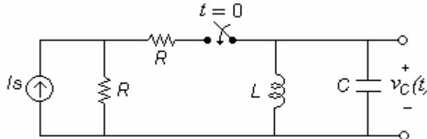
3. En el siguiente circuito  $i_L(t) = 50e^{-10t} \operatorname{sen}(10\sqrt{3}t)$  A para todo  $t \geq 0$ . Encontrar el valor de C que produzca esta respuesta. Luego calcular las condiciones iniciales  $v_C(0^+)$ ,  $v'_C(0^+)$  y  $v_C(t)$  para  $t > 0$ .
