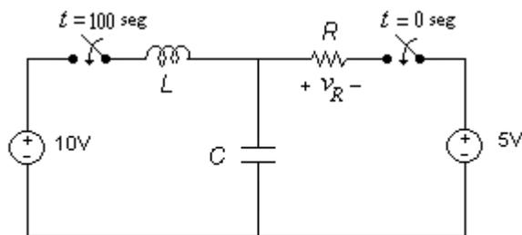
2. (30/100) Encontrar un modelo (circuito equivalente) y plantear sus ecuaciones para calcular  $v_C$  en estado estable si la fuente es:
