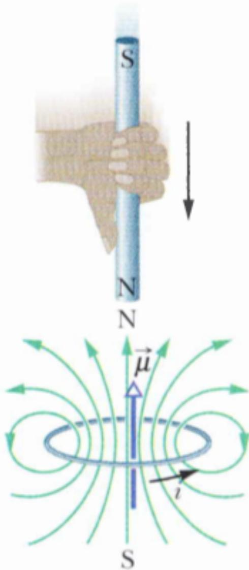
Una corriente inducida tiene una dirección tal que el campo magnético debido a la corriente inducida se opone al cambio de flujo magnético que induce la corriente
